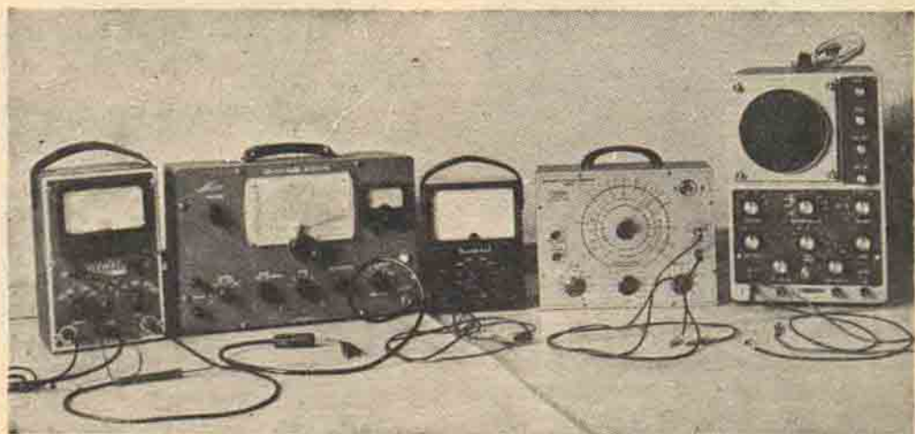
Radio alıcılarıyla uğraşan ileri durumdaki amatörler'e yarayacak aletler sırasıyla görülmektedir: elektronik tüplü volmetre, modüle yüksek frekans üreteci, multimetre, direnç-kapasite ölçme köprüsü, katod ışıklı osiloskop.
