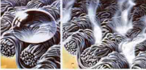
Trevira iplikten yapılan "reetdach": Kumaş parçası (fotoğrafta), yağmur damlalarını geri çevirdiği halde, su buharını geçiriyor (çizimler).
