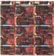
Elektronik göz: Işığı algılayabilen çip (solda) retinadaki hasar görmüş fotoreseptörlerin yerine görev yapabileceklerdir.
