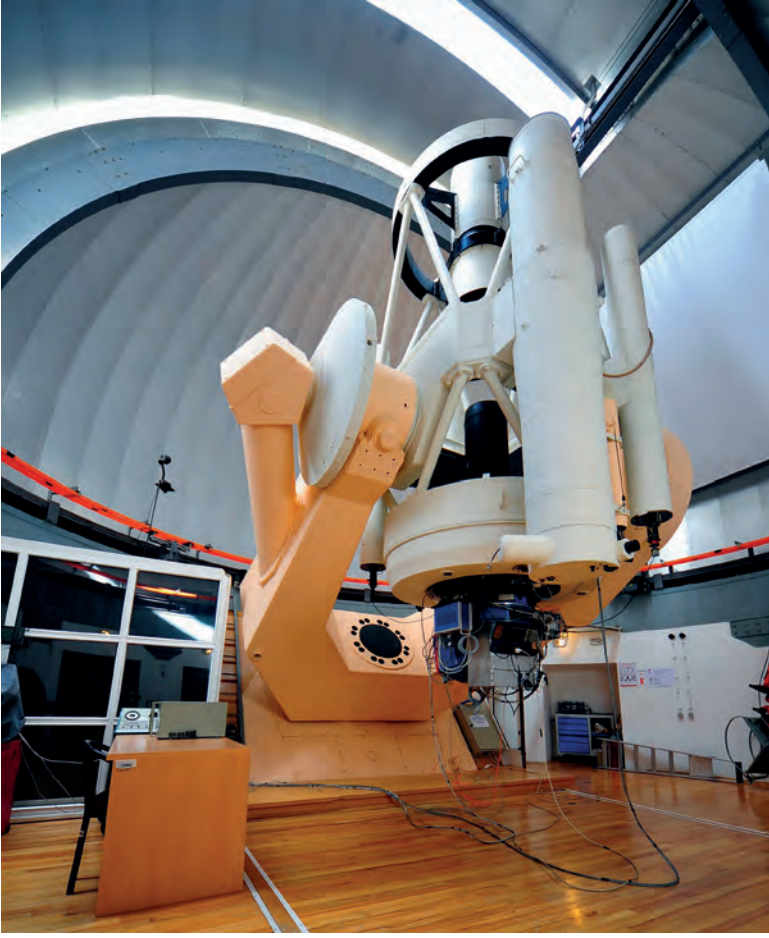
1,5 m ayna çapıyla ülkemizdeki en büyük optik teleskop RTT150 (üstte)
