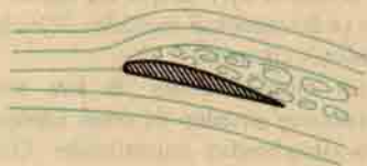
ŞEKİL 6 : Üst hava dolaşımının, fazla büyük hücum açısının etkisinde kopması
