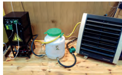
Bitcoin üretmek için kullanılan ısıtma mekanizması
