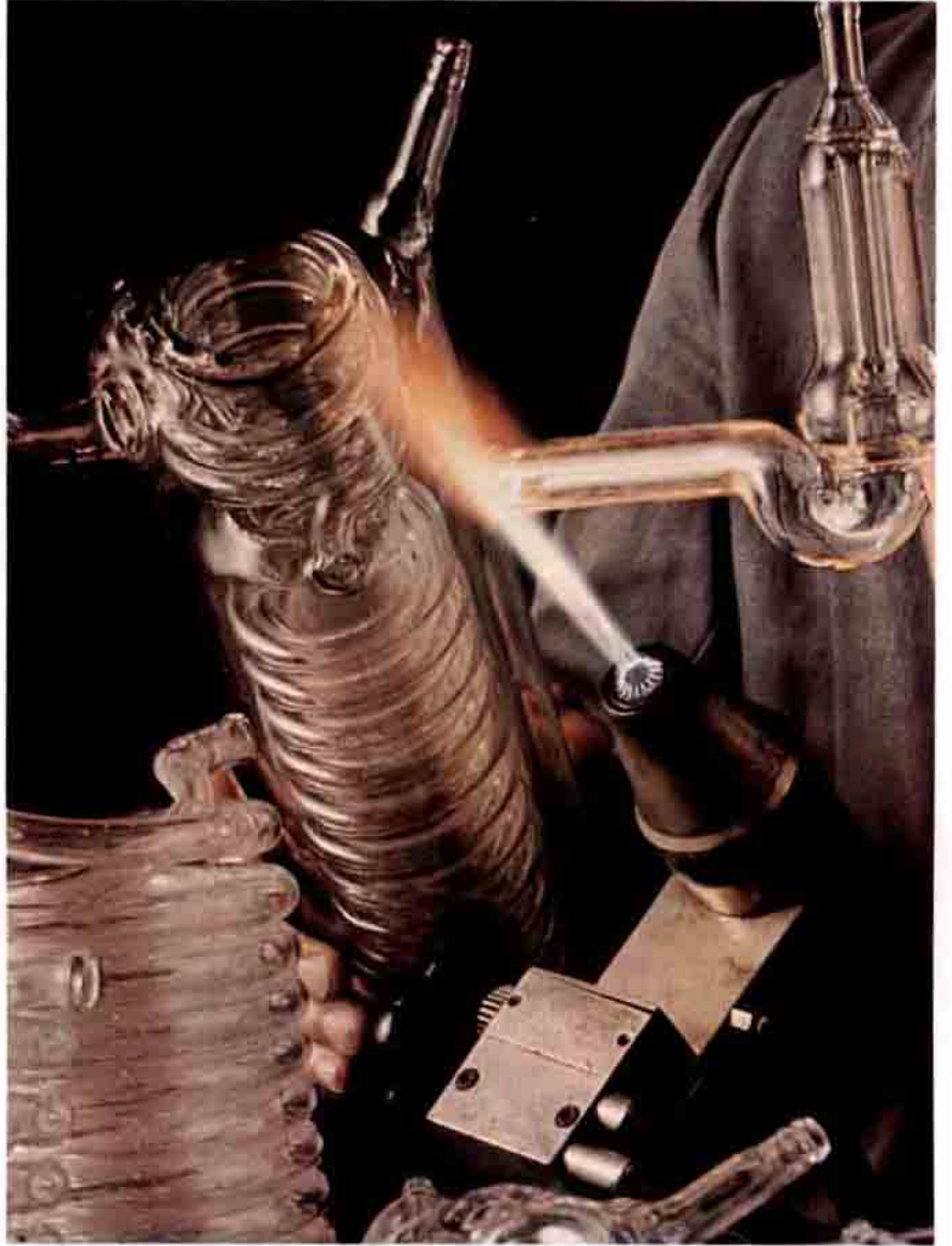
Spiralli soğutucu yapan bir cam teknisyeni görünüyor. Daha önceden ana parçaları hazırlanan soğutucu ateş yardımı ve el hünéri ile birleşiyor.
