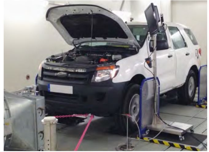
Şekil 4. Şasi dinamometresinde yapılan örnek araç testi
