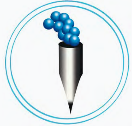
Hücreler besleyici ve koruyucu bir madde ile birlikte karıştırılarak kartuşa doldurulur.
