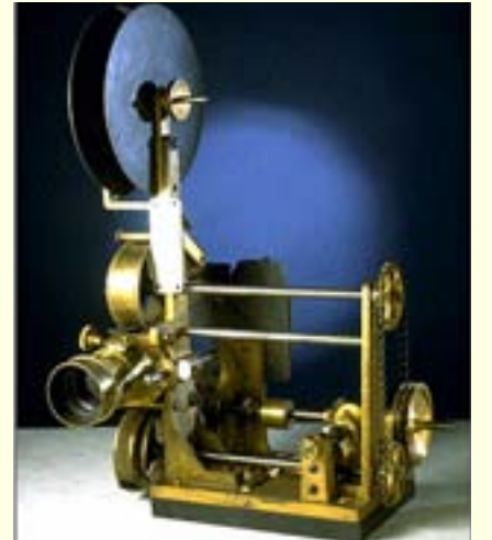
Lumière'lerin geliştirdiği Cinématographe'in ön, arka ve iç yapısını görüyoruz. Aslında gördüğümüz aygıt dünyanın ilk sinema makinesi.
