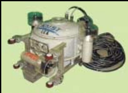
Turtle I in gelişmiş bir model olarak tasarlanan Turtle II'nin eyleyicilerinde bir değişiklik yapılmamış. Ana denetim birimi olarak Intel 80196 mikroişlemci kullanılmış. Turtle II, kamera ve basınç dönüştürücüsü yanında, radyasyon tespit ve sızıntı algılama algılayıcılarına sahip. Boyutları: 620mm x 520mm x 300mm.
