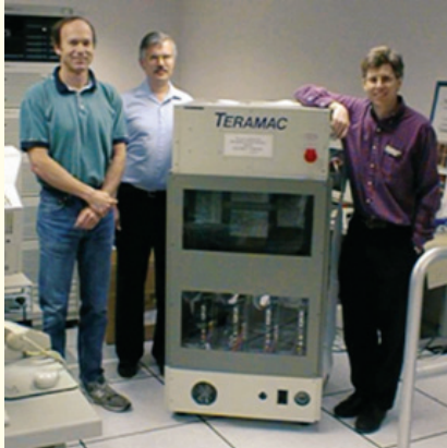
Şekil 2: HP Laboratuvarları'nda geliştirilen Teramac sistemi geleceğin nanoelektronik bilgisayarları için bir çıkış noktası oluşturuyor. 1000 GHz'lik bir bilgisayarın işlem gücüne sahip olan Teramac kasıtlı olarak hatalı parçalardan yapılmasına rağmen doğru çalışıyor.
