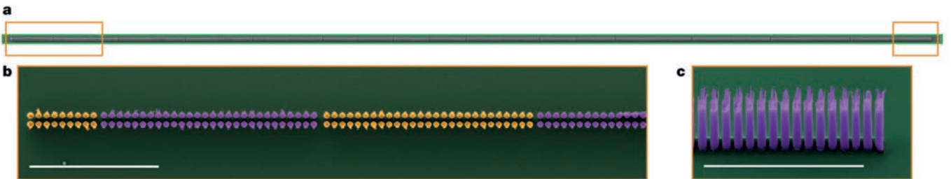
Tomáš Chlouba ve arkadaşları tarafından geliştirilen hızlandırıcıların renklendirilmiş elektron mikroskobu görüntüleri. Kanala bir uçtan giren elektronlar diğer uçtan hızlanmış olarak çıkıyor (a). Her biri yaklaşık 2 mikrometre yüksekliğindeki sütunların yukarıdan (b) ve yandan (c) görünüşü. Aralıklı olarak dizilmiş sütunlar hem elektronların kanalın dışına çıkmasına engel oluyor hem de elektronlara enerji aktarılmasına aracılık ediyor.
