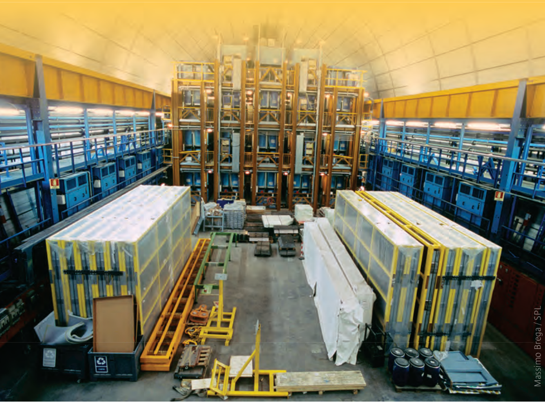
İtalya'daki Gran Sasso Dağı'nın içinde nötrino araştırmaları için kurulmuş LVD (Large Volume Detector) dedektörü
