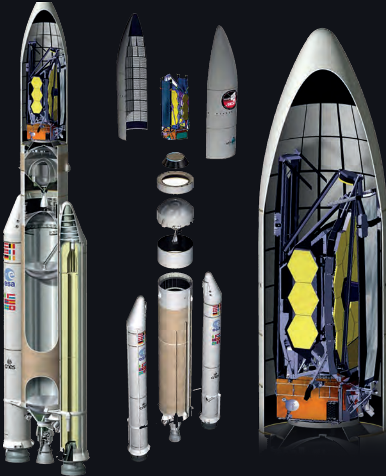
JWUT'un uzaya çıkmadan önce Ariane 5 roketinde paketlenmiş gösterimi (ESA)
