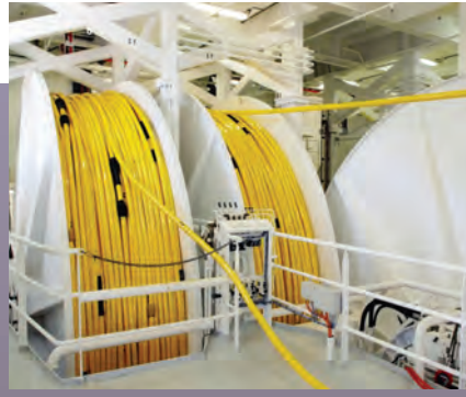
Şekil 5. Sismik gemilerde kullanılan alıcı kablolar.
