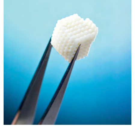
Biyoaktif cam kullanılarak üç boyutlu üretilmiş bir doku iskeleti
