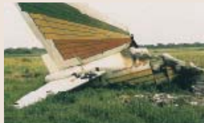
15 Eylül 1988'de Etopya Bhardar Havaalanı'ndan kalkışı sırasında kuş sürüsü ile çarpışarak düşen Boeing 737 tipi bir uçaktan geriye kalanlar.
