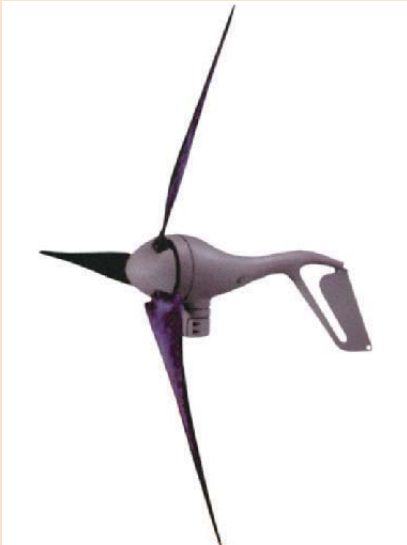
Şekil 2: Bu model, rüzgar hızı 10 km/saat iken çalışmaya başlıyor ve 40 km/saat'te, 400 w'lık tasarım gücüne ulaşıyor. 12 veya 24VDC gerilim üretiyor ve şarj denetleyicisine sahip. Denetleyicinin gelişkin kontrol devreleri; yüksek rüzgar hızlarında rotor palalarının açısını değiştirmek suretiyle dönme hızını düşürüyor ve böylece, hem sarsıntıları ve gövde üzerindeki aşırı yükleri önleyip, hem de gürültüyü azaltıyor. Aküyü şarj işlevini de, voltajını devamlı yaklayarak, kontrollü bir şekilde yerine getiriyor. Fiyatı 600 ABD doları kadar.
