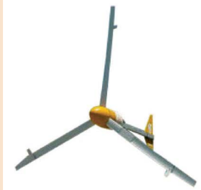
Şekil 3: Bu modelin, 7,5 ve 10 kw'lık iki tipi var. 10 km/saat'lik rüzgar hızlarında çalışmaya başlıyor ve tasarımı, 180 km/saat'e kadarki hızlara dayanabiliyor. Çok değişken rüzgar koşullarında üretim yapabilmesi ve sahip olduğu yüksek güç düzeyi, konut uygulamaları için uygun. Türbin çıkışında üretilen gerilim 120 VAC. Şarj denetleyicisi ve AC-DC çeviriciye ek olarak bir de, 4'e 1 sarımlık trafoya sahip. Dolayısıyla, 120 VAC'lik türbin çıkışını, hem dönüştürüp hem de düşürerek, 24VDC'lik bir akü grubunu besleyebiliyor.
