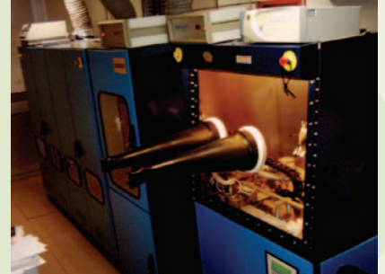
Mavi ışık kaynağı üretiminde kullanılan kristal büyüme sistemi: Metallo Organic Chemical Vapour Deposition (MOCVD) sistemi.
