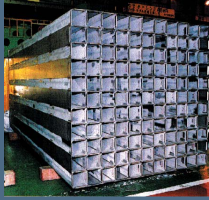
Bor katkılı paslanmaz çelikten yapılmış profiller, nükleer santrallerde kullanılmış yakıt çubuklarının daha büyük miktarlarda depolanabilmesini sağlıyor.
