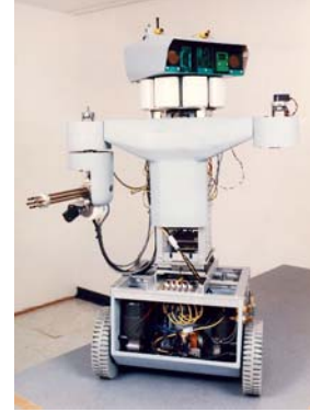
Şek. 7: Çok sayıda algılayıcı ve silahları ile robot koruyucu.
